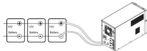
**Шаг 5.** Соблюдайте полярность и в процессе присоединения клемм аккумулятора к соответствующим клеммам на задней панели прибора.
